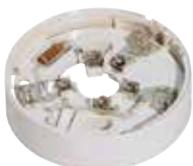
Base estándar alta con resistencia limitadora de corriente de 470 Ohmios para instalaciones con tubo visto para sensores de las series 400, 600 y 800. Con el adaptador BA1AP-IV permite la entrada de tubos de 18 y 20 mm de diámetro exterior. Dispone de automatismo de bloqueo y terminales de conexión para cable de hasta 2,5 mm<sup>2</sup>.
