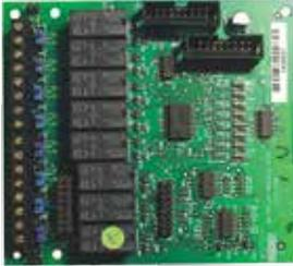
Tarjeta de ampliación con 8 salidas de relés configurables. Se puede instalar un máximo de 2 tarjetas 020-747 en cada central de la serie NFS.
