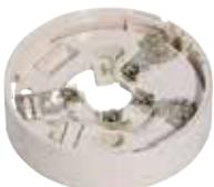
Base estándar alta para instalaciones con tubo visto para sensores de la serie 400, 600 y 800. Con el adaptador BA1AP-IV permite la entrada de tubos de 18 y 20 mm de diámetro exterior. Dispone de automatismo de bloqueo y terminales de conexión para cable de hasta 2,5 mm<sup>2</sup>.
