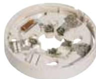
Base estándar de superficie con resistencia limitadora de corriente de 470 Ohmios para detectores convencionales de las series 400, 600 y 800. Dispone de automatismo de bloqueo y terminales de conexión para cable de hasta 2,5 mm<sup>2</sup>.
