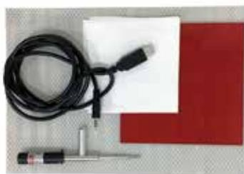
KIT instalación OSID con herramienta láser, cable de diagnóstico y filtro de prueba.
