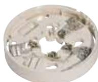
Base estándar de superficie para detectores convencionales de las series 400, 600 y 800. Dispone de automatismo de bloqueo y terminales de conexión para cable de hasta 2,5 mm<sup>2</sup>.
