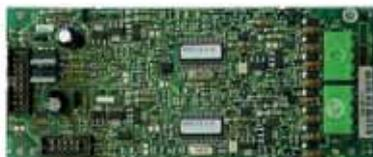
Tarjeta interfaz estándar que amplía 2 lazos analógicos direccionables, controlados por microprocesador principal. Capacidad para controlar 99 detectores analógicos y 99 módulos por lazo, hasta un total 396 puntos identificables.
