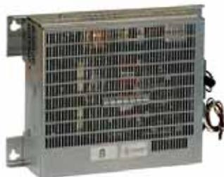
Fuente de alimentación para el sistema ID3000, configurable de 4,5 ó 7A. Incluye cables de interconexión y fusibles. Se puede instalar en el interior de la cabina ref 020-474-009 (recomendada sólo para F.A. de 4,5A) o en la cabina para F.A. externa ref 020-541-009. Capacidad para cargar baterías de 130Ah. La corriente disponible configurada a 7A. es de 4A. en reposo y de 7A. en alarma.
