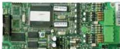
Tarjeta interfaz microprocesada que amplía 2 lazos analógicos direccionables con microprocesador de reserva incorporado. Capacidad para controlar 99 detectores analógicos y 99 módulos por lazo, hasta un total 396 puntos identificables.
